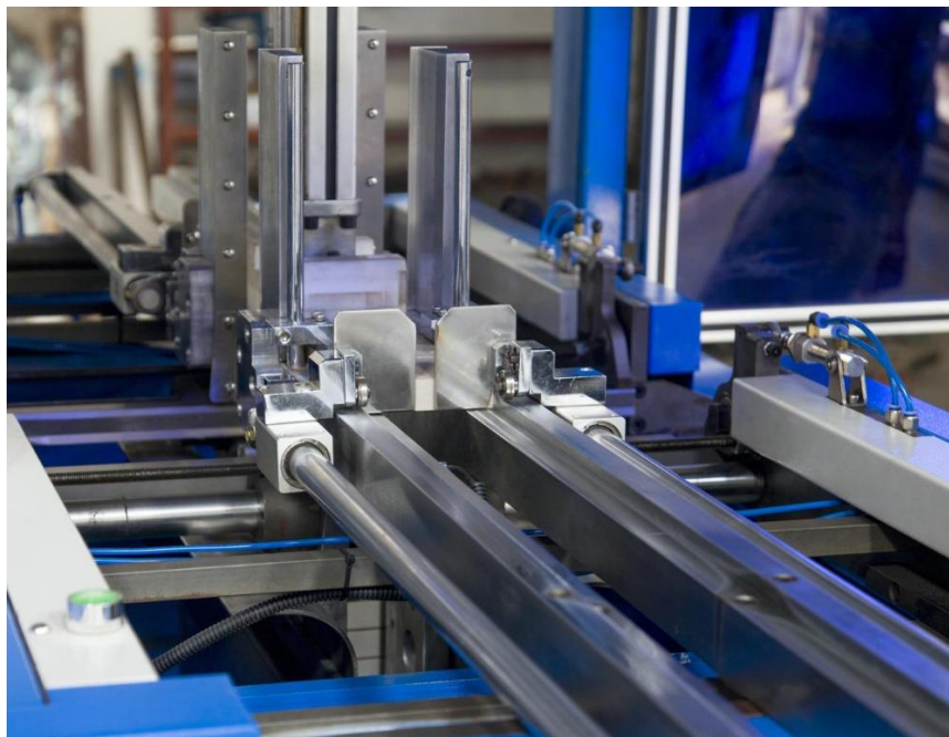
Samonakładak formatek bocznych z zabieraniem dolnym
